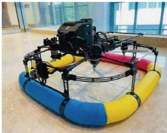
TA-Q3的最小作业渠盖直径为0.7米,体积仅为647×767×435毫米。单手就能拎起的重量,不到3千克。
