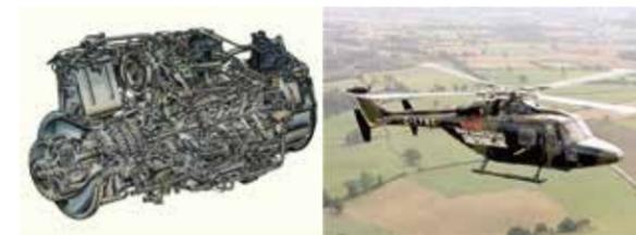
图1 Gem涡轴发动机(左) 配装WG.13山猫直升机(右)
