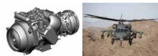
图3 HPW3000涡轴发动机(左) 拟配装UH-60系列直升机(右)
