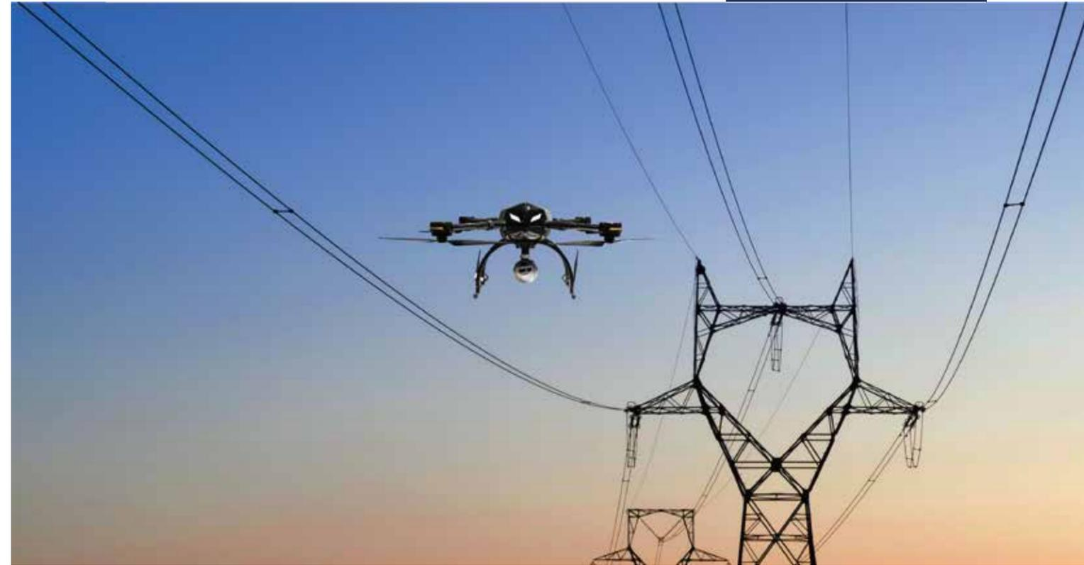
应等功能，抗风6级，使用温度为零下四十度到零上五十度等优势，完全满足电力精细化巡检的应用需求。
