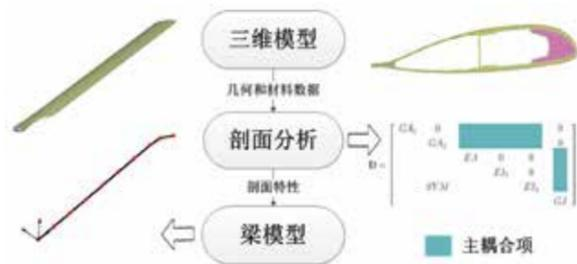
图3 结构桨叶模型
