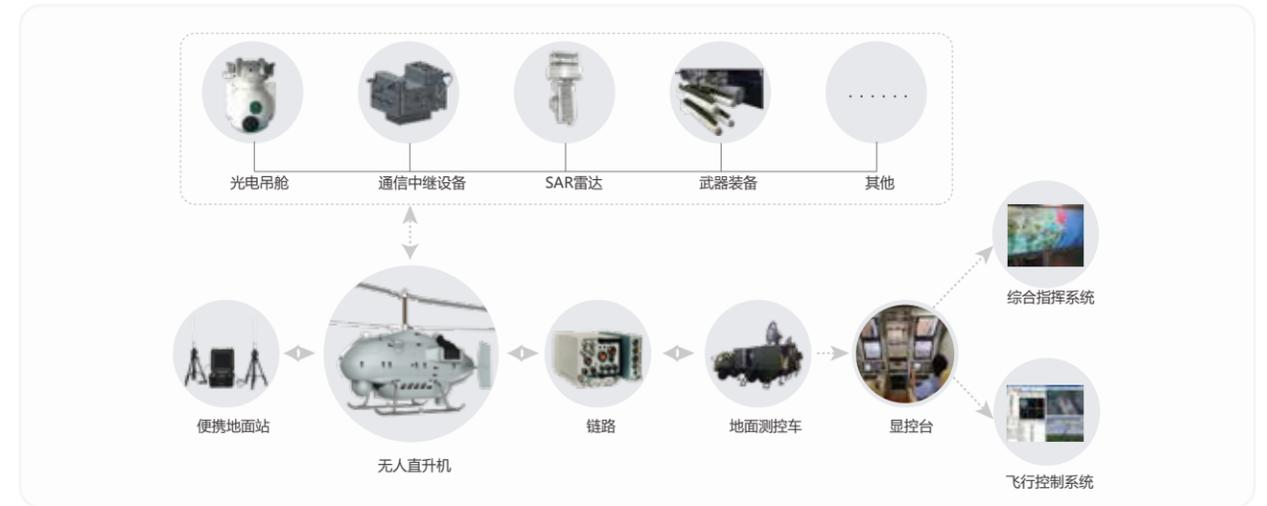
TD220机型结构紧凑,机体小,对起飞环境要求低。尤其它的模块化设计、共轴反桨构造,避免了尾桨失效风险,进一步提升了安全性,能够在多种恶劣环境中作业且维护简单。
