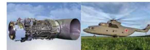
图2 D-136涡轴发动机(左) 配装米-26直升机(右)
